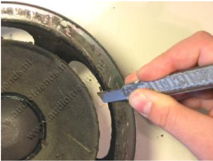
11. Schraap met de achterkant van het Stanley-mesje voorzichtig de zacht geworden foam weg.
